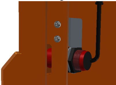
S10 - door magnet switch
