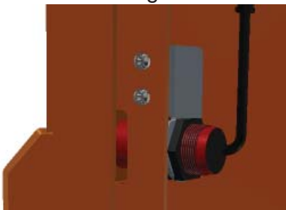
S10 - door magnet switch
